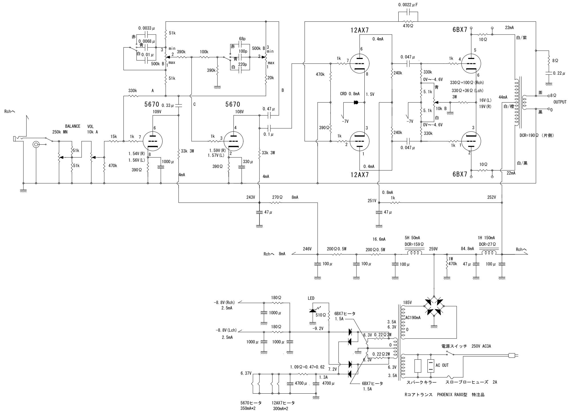
各部の電圧はAC電源=AC101Vの時に特定した実測値
